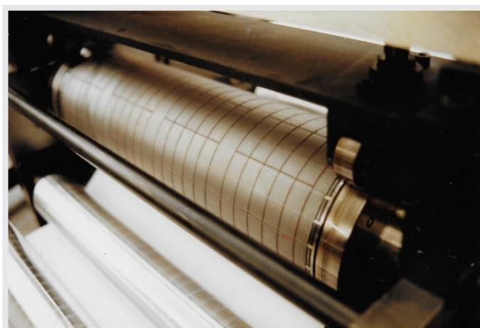
(2) La coupe s'effectue entre ce cylindre et un second également en acier dont l'écartement et la pression doivent être réglés avec une infinie précision pour obtenir le bon niveau de profondeur de coupe.
